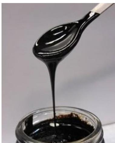
Figure 56 : Huile de liquéfaction hydrothermale, ou bio-brut
