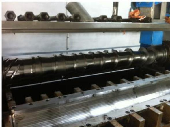
Figure 18 : Presse à vis, cage ouverte
