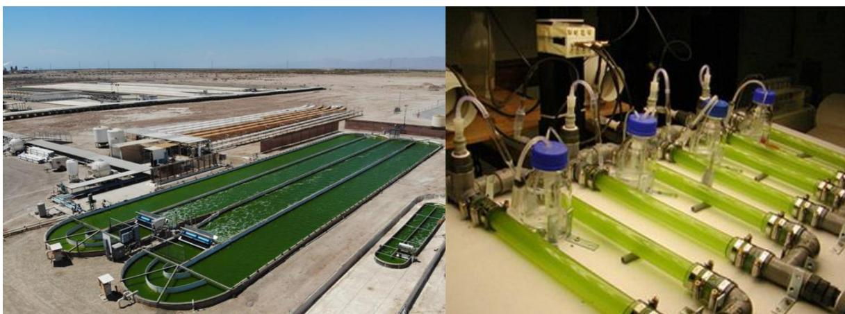
Figure 81 : Raceway (ouvert) et réacteurs (fermé) pilotes de production d'algues
