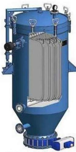
Figure 19 : Filtre vertical (coupe) à grilles
