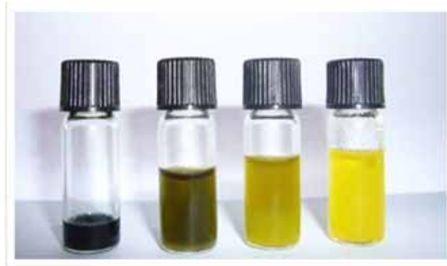
Extractos de Artemisia absinthium . De izquierda a derecha: Hidrodestilado, Soxhlet (etanol y hexano) y con CO 2 Supercrítico.
