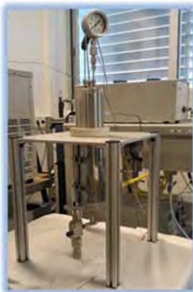
Principio de Funcionamiento de la Técnica SAE. Detalle de la Cámara I3A - Unizar
