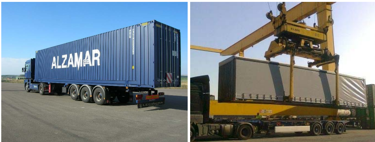
Figura 2: Caixa mòbil de 45' sobre vehicle de carretera(esquerra) i grua RTG elevant una caixa mòbil pels seus laterals
