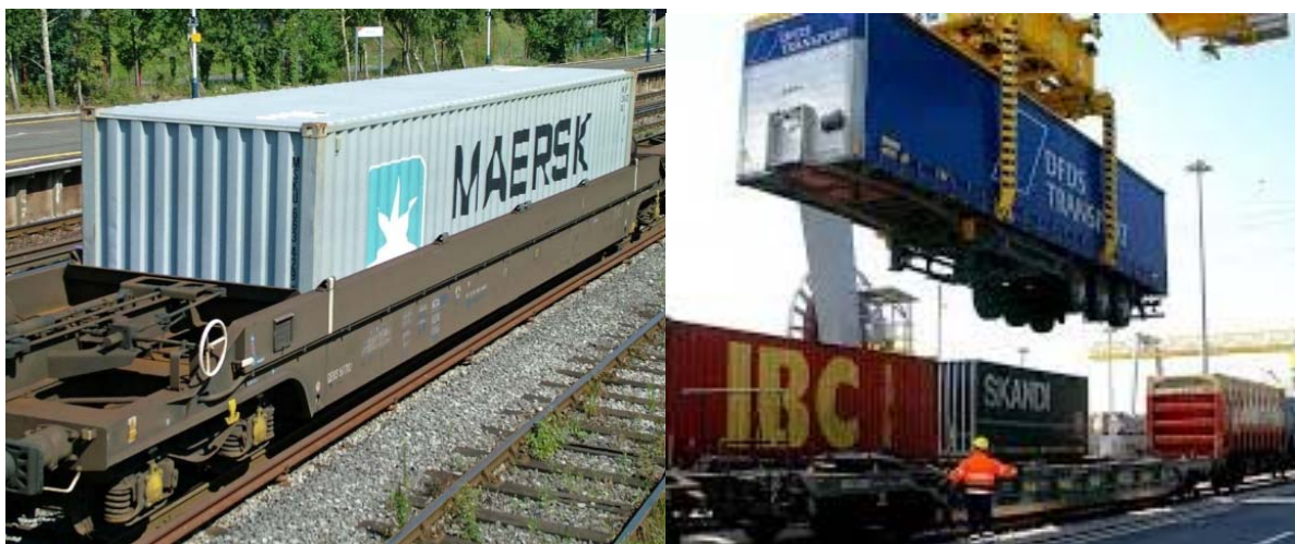
Figura 6: Sistema de càrrega/descàrrega en vagons poche
