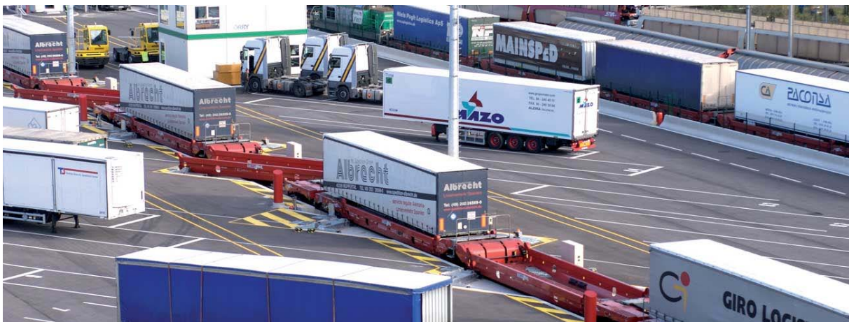
Figura 3: Sistema de càrrega/descàrrega mitjançant el sistema Modalhor
