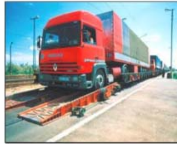
Proceso de descarga de una carretera rodante
