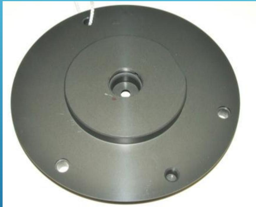
**Componente in lega di alluminio 6082-T6 trattato con Oxide Nero 55µm dopo 1250h di nebbia salina. Test eseguito alla temperatura di +35°C e con ciclo termico -54°C /+71°C x 35gg ( su due flangie)**
