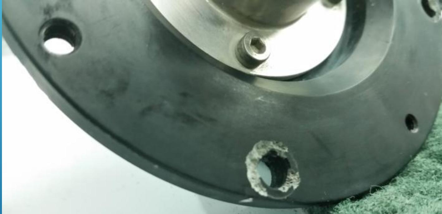
**Componenti in lega di alluminio 7075-T6 trattati con Ossidazione anodica Dura NERA secondo MIL-A-8625 tipo III classe II - 50µm e assemblati con componenti in acciaio inox AISI316 dopo 245h di immersione in mare.**
