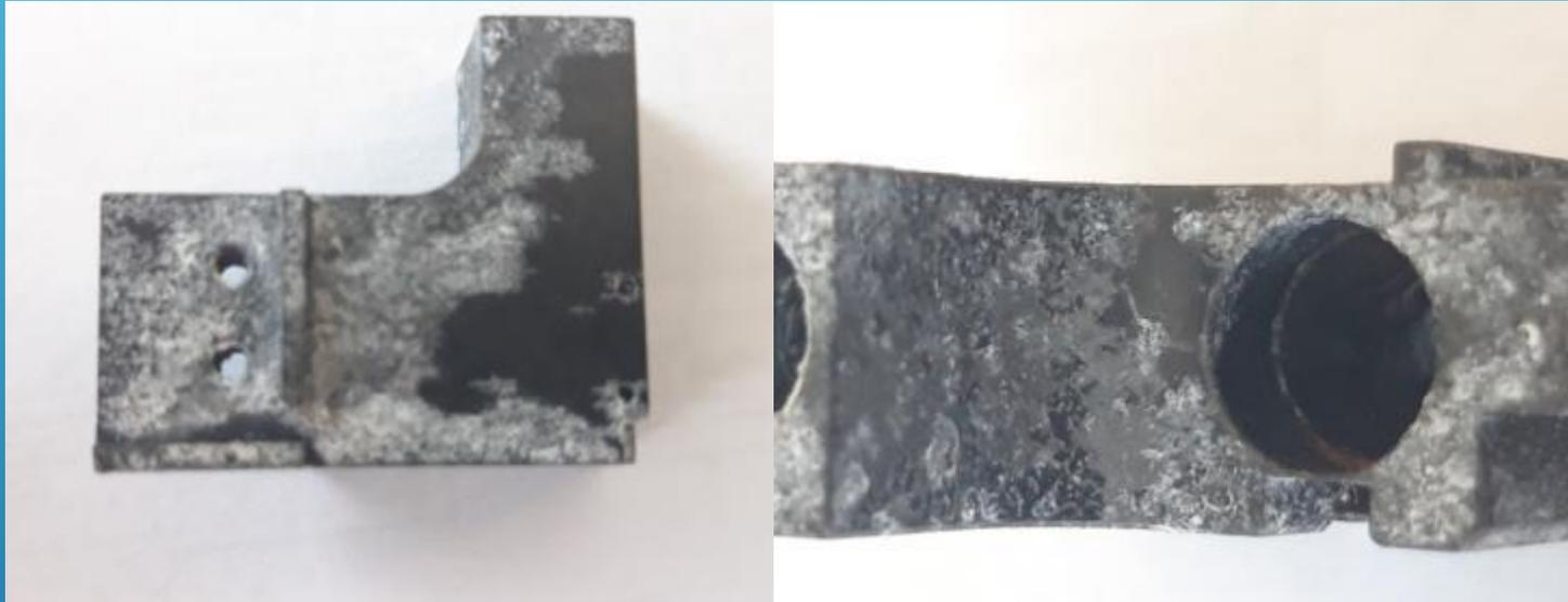
**Componente in lega di alluminio 7075-T6 trattato con Ossidazione anodica Dura NERA secondo MIL-A-8625 tipo III classe II - 50µm dopo 440h di nebbia salina.**
