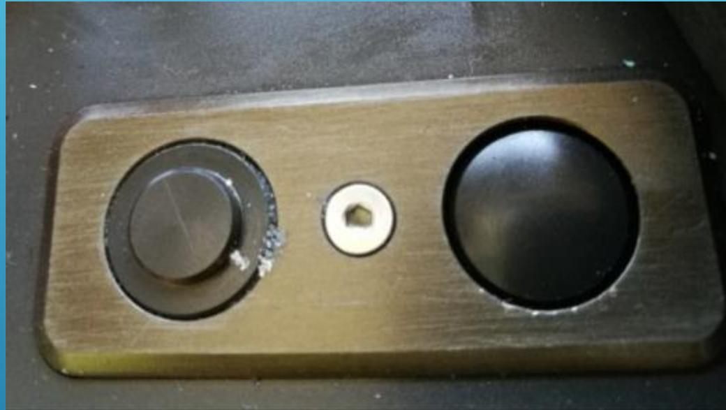
**Componenti in lega di alluminio 6082-T6 e 7075-T6 trattati con Oxide Nero 55 $\mu$ m e assemblati, dopo 1250h di nebbia salina. Test eseguito con ciclo termico -54°C /+71°C x 52gg ( su 8 assiemi )**
