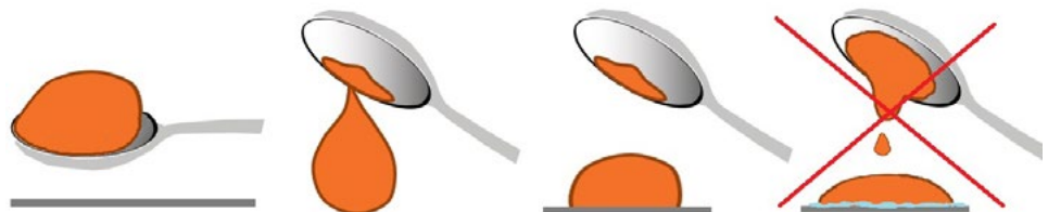
Figura 17. Test de inclinación de cuchara de la IDDSI.
