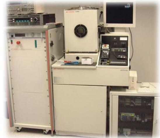
Vakuum-Magnetron-Sputteranlage von Edwards (Material Center Tirol)
