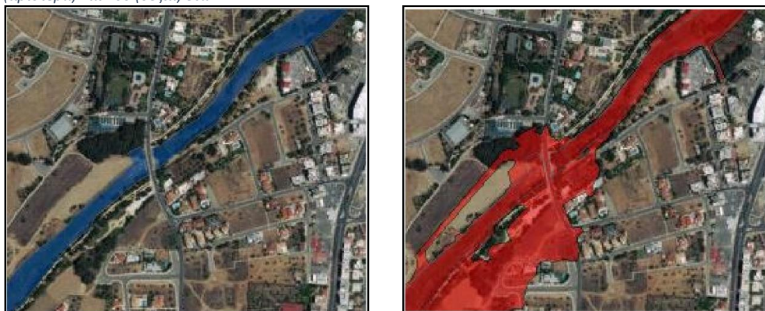
Εικόνα 45: Προσομοιώσεις του Δυναμικού Μοντέλου Πλημμυρών του DECAT για Περίοδο Επαναφοράς 20 (αριστερά) και 100 (δεξιά) ετών
